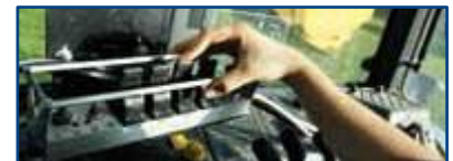
CONSOLLE ELETTROPROPORZIONALE per movimentazione bracci
